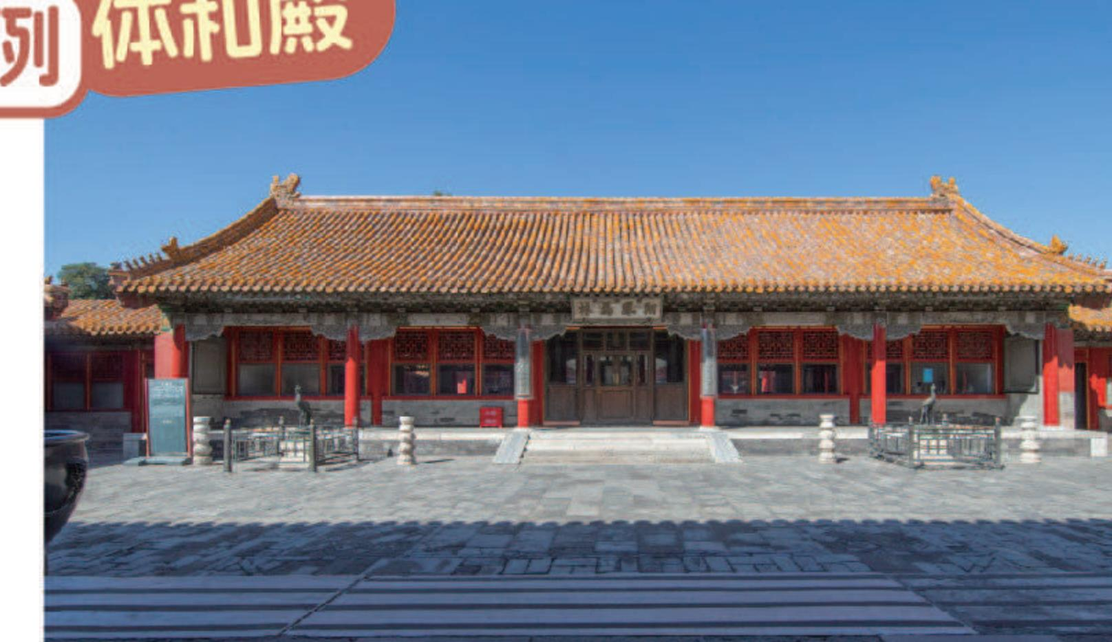
**重檐盝顶** 好像将坡屋顶的上端平切一刀，再用脊围成平顶。
